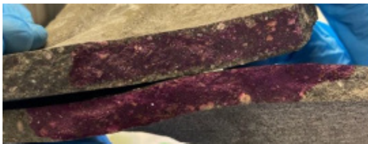
Figur 1: Den övre takpannan är obehandlad och den under är ytbehandlad med Benders benderitfärg. Det lila området indikerar icke-karbonatiserad betong.
